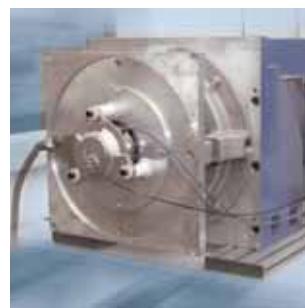
Banco de ensayo para contactos toma de tierra. Medición del desarrollo de temperatura de las escobillas
