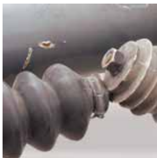
Rotura del husillo del accionamiento de un pantógrafo, causada por una fuerte influencia exterior
