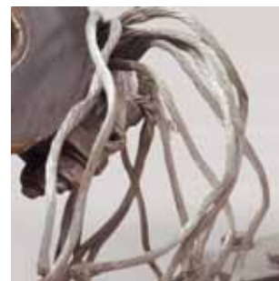
Trencillas de corriente de un pantógrafo rotas
