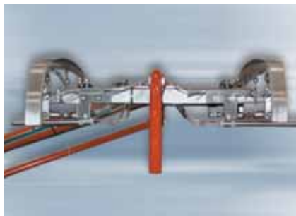
Vista detallada de un pantógrafo de pruebas. Bien visible, a izquierda y derecha bajo los frotadores: Tubos Pitot para la medición de la velocidad del viento
