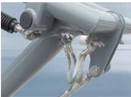
Cojinetes principales renovados, trencillas de corriente nuevas: Óptima seguridad de servicio
