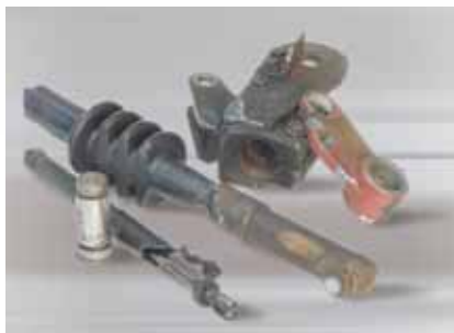
Dependiendo del tiempo de servicio y del esfuerzo: cojinetes, conexiones y piezas transmisoras de corriente deteriorados
