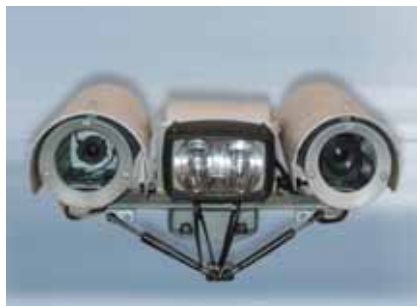
Con la cámara instalada en el tren de medición, se observa el comportamiento del pantógrafo durante el recorrido. Se reconocen, a tiempo interrupciones y averías
