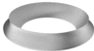
Pieza de la cámara de combustión de la tobera del cohete espacial Ariane con revestimiento de SiC
