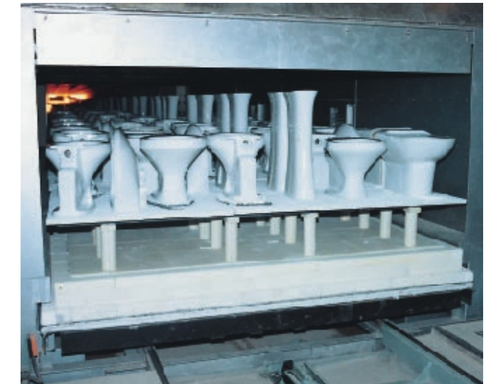
Horno túnel con vagoneta (Drayton)
